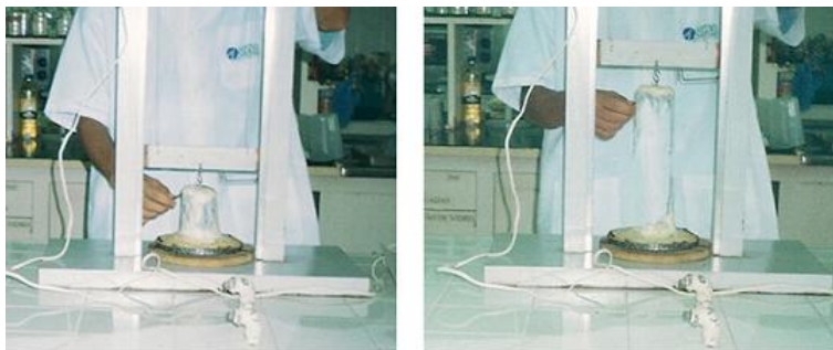
Figura 1 – Obtenção da elasticidade do queijo mozzarella para pizza , utilizando de um teste instrumental empírico
